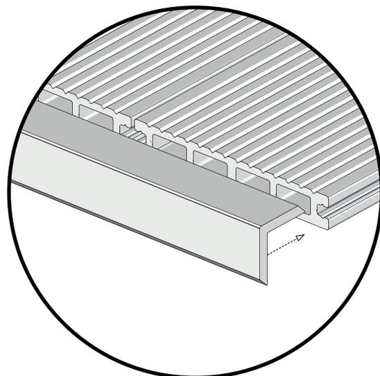
**Торцевая заглушка** для декорирования торцов доски. Защищает от попадания влаги внутрь доски. Проклеивается при монтаже.
