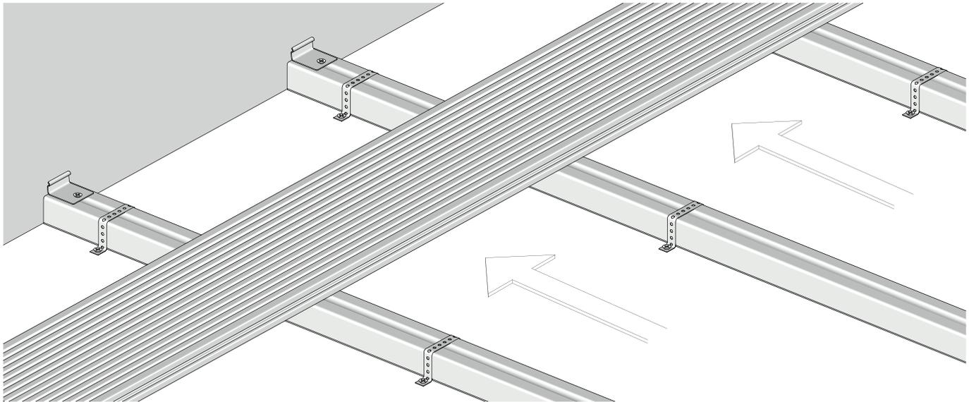
Для равномерного зазора и полного прилегания доски используйте киянку. **ВАЖНО** - Не подбивайте доски вплотную друг к другу, это нарушит отток воды с поверхности и вентиляцию настила.
